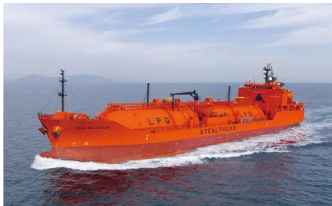
LPG船はセミレフと加圧式の双方に対応
